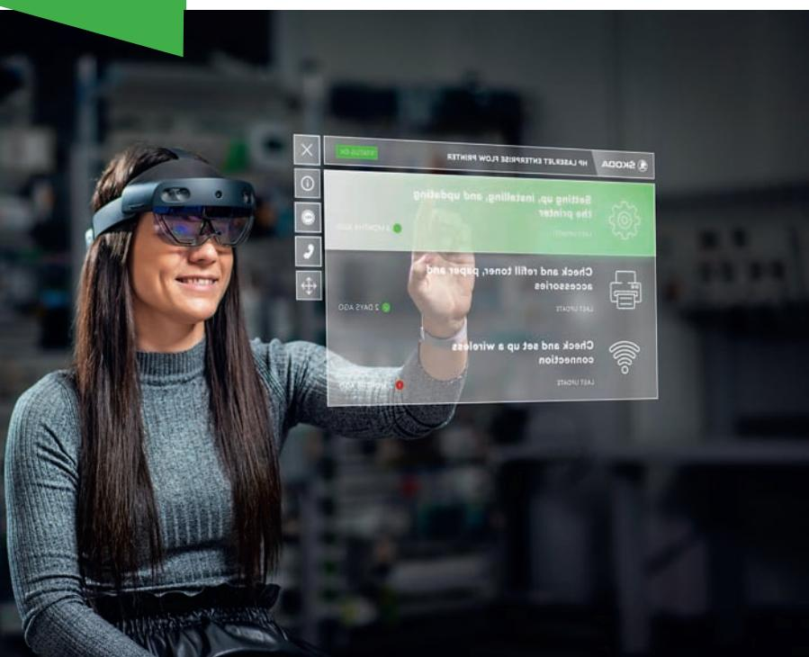
Центральний відділ технічної служби ŠKODA AUTO випробовує технології доповненої реальності при обслуговуванні виробничих ліній у рамках пілотного проекту. Під час відеодзвінків техніки можуть використовувати окуляри, аби показати, що вони бачать на лінії, та проконсультуватися з колегами, які не перебувають на місці. Окуляри також можна використовувати для обміну технічними файлами та іншими документами.
