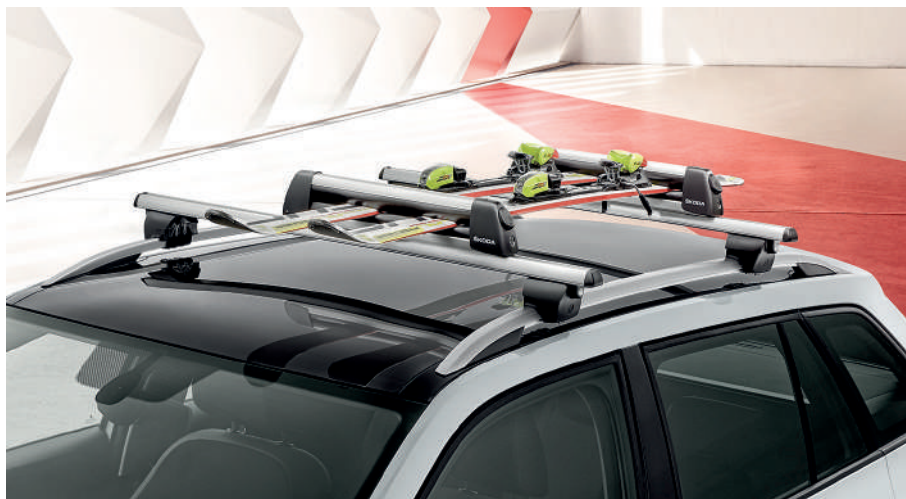
Багажне кріплення для лиж та сноубордів - алюмінієвий профіль (000 071 129H)
