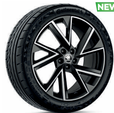
Vega 6VO 071 498 JX2 легкосплавні диски 7.5J x 18" ET46 для 215/35 R18 шин ET46 чорний глянцевий ŠKODA Оригінальні Аксесуари
