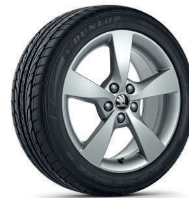
Dione 5JA 071 496B 8Z8 легкосплавні диски 7.0J × 16" для 215/45 R16 шин ET46 срібний металік ŠKODA Оригінальні Аксесуари
